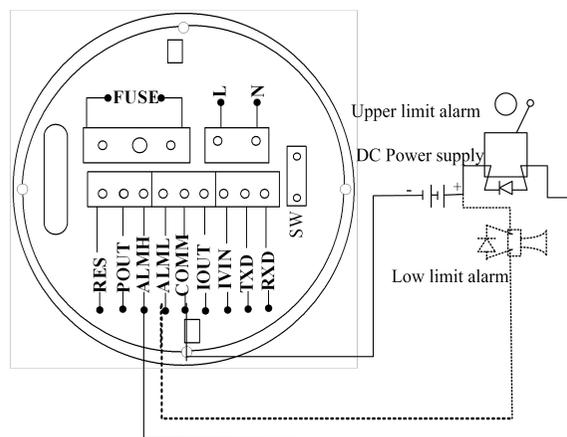
Fig 4.4.2(d) Connection of Alarm Output
